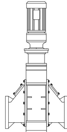
**Конструкция: Фланцевое соединение ин-лайн**
